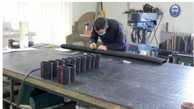
*L'atelier découpe et collage de caoutchoucs et plastiques, avec système d'extraction d'air pour le collage. Le négoce peut notamment réaliser des bandes transporteuses à la demande pour les industries et les exploitations agricoles.*
