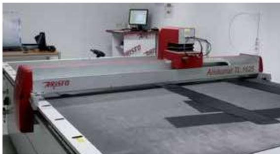
*La machine de découpe numérique de joints d'étanchéité, essentiellement réalisés dans des plastiques fins.*
